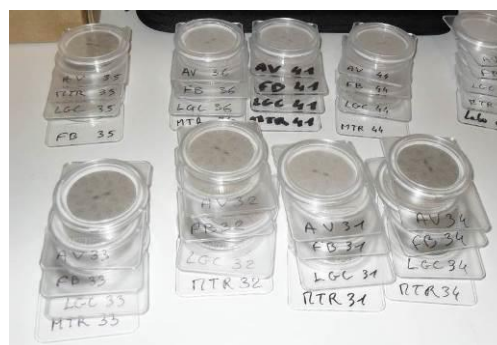
Figure 3 : Exemple de série de filtres après prélèvements des particules PM10 et avant dosage des métaux
