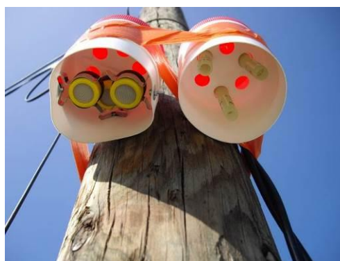
Figure 4: Exemple d'installation de tubes passifs NO 2 (à droite) et SO 2 (à gauche).
